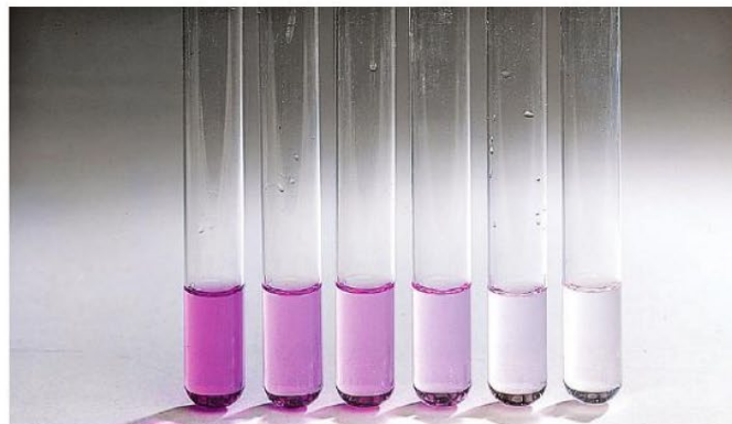
Doc. Échelle de teintes utilisée pour un dosage par étalonnage de l'ion permanganate.
